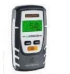
Độ ẩm bề mặt bê tông \geq 5\% chưa đạt
