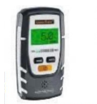
Độ ẩm bề mặt bê tông ≥ 5% chưa đạt
